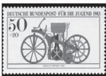
В качестве топлива мог быть использован бензин или керосин. Чтобы запустить силовой агрегат, изначально нужно было бензиновым нагревателем раскалить медную калильную трубку, которая в дальнейшем воспламеняла горючую смесь. Двигатель запускали заводной рукояткой, и если всё было хорошо, то эта операция занимала приблизительно одну минуту. Мотоцикл был сконструирован Готлибом Даймлером и его партнёром Вильгельмом Майбахом.
